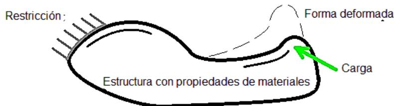
En un problema de mecánica, el objeto podría ser un engranaje, la carga podría ser una fuerza aplicada por otro engranaje, la respuesta podría ser las tensiones a lo largo del engranaje. La restricción es que el engranaje debe permanecer sobre el eje.
