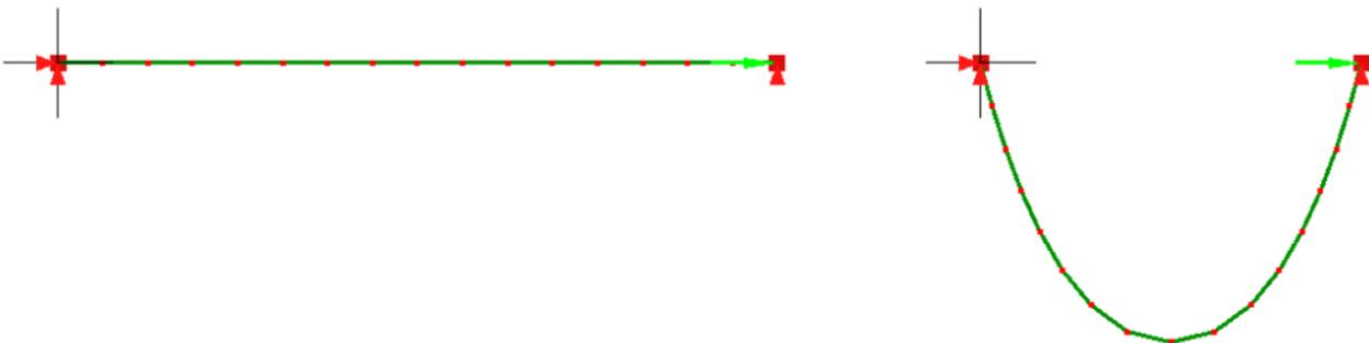
En time=1s el cable se tensa (a la izquierda) en time=2s se aplica la gravedad causando que se doble (derecha).
