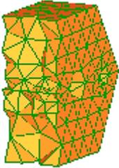
**Mesh tools** → **Hollow** se utiliza para convertir una malla sólida en una malla de cáscaras.
